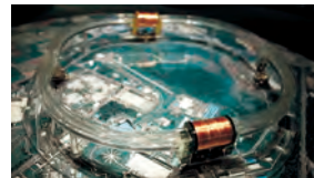
KEKの敷地内を巡る周長約3kmの加速器。その仕組みを電磁石とパチンコ玉で紹介する装置
