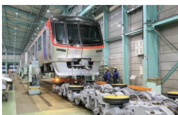
台車の取付作業
