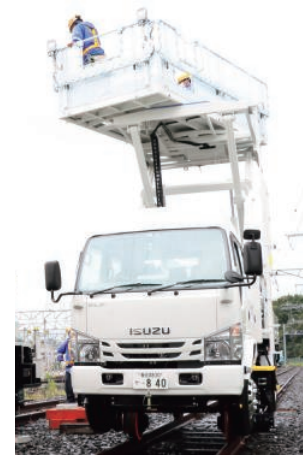
旋回作業台車付軌陸車
