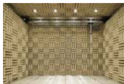
音響実験棟の無響室
