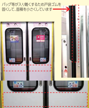
一部車両のドアには、このように低摩擦テープを貼り付けて効果を検証しております
