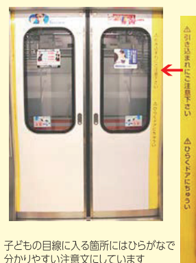
一部車両のドアには、このように低摩擦テープを貼り付けて効果を検証しております
