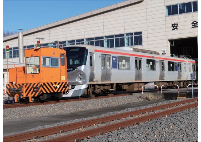
○車体更新作業終了後のTX-1000系
