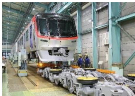
台車の取付作業
