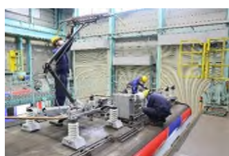
屋根上機器の取付確認
