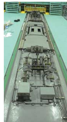
屋根の絶縁塗装
