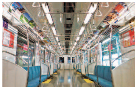
LED照明にしたTX-1000系
