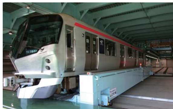
1両を平面移動できるトラバーサー
