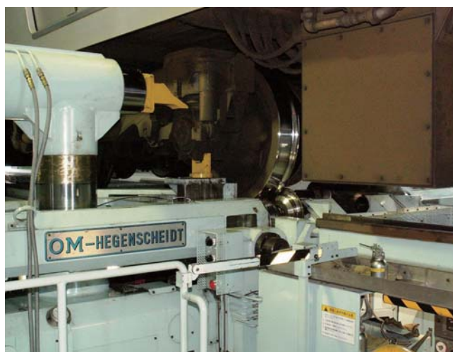
車輪旋盤装置による削正
