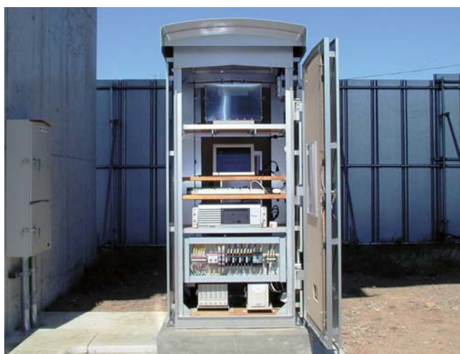
フラット検出装置の測定器具
