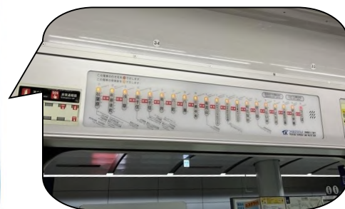
車内に設置されている表示器 (TX-1000 系、TX-2000 系)
