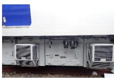
主制御装置に SiC 素子を適用
