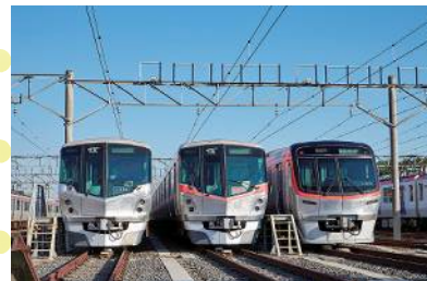
車両は直流専用のTX-1000系、交流用のTX-2000系、TX-3000系がある
